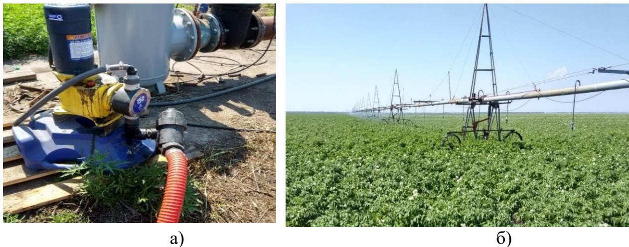
Рисунок 1. Фертигация картофеля жидкими минеральными удобрениями КАС+S: а) - дозатор, б) - дождевальная установка «Фрегат» на поливе картофеля
